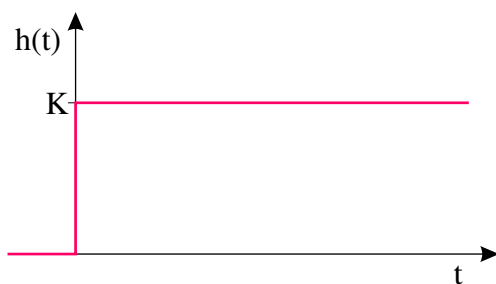
Abbildung 2.17: Sprungantwort und Blockschaltbild eines P-Glieds
